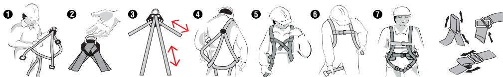
Fig.1. Desplegar completamente el arnés. / Fig.2. Coger el arnés por la hebilla dorsal. / Fig.3. Ajustar a la medida del usuario mediante el regulador dorsal. / Fig.4. Colocarse el arnés con el regulador y la piqueta situados en la espalda. / Fig.5. Ajustar y abrochar la hebilla frontal. / Fig.6. Ajustar y abrochar las hebillas de las perneras. / Fig.7. Ajustar y abrochar el cinturón.
